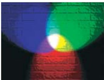
Em computação gráfica, o sistema *RGB* identifica uma cor a partir de três números *R*, *G* e *B* que especificam, respectivamente, as quantidades de vermelho (*Red*), verde (*Green*) e azul (*Blue*) que compõem a cor. Outro sistema de identificação de cores é o NTSC (usado em TV). Nesse sistema, uma cor também é definida por três números: *Y* (luminância), *I* (sinal em fase) e *Q* (quadratura). Os dois sistemas estão relacionados através da seguinte equação matricial:
